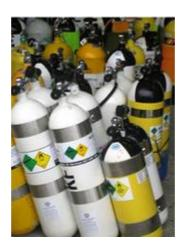
Le bottiglie in acciaio, per essere preservate dalla corrosione, necessitano di rivestimenti. Generalmente, quindi, vengono zincate ed infine verniciate esternamente con processi particolari per ancorare opportunamente la vernice alla superficie.
